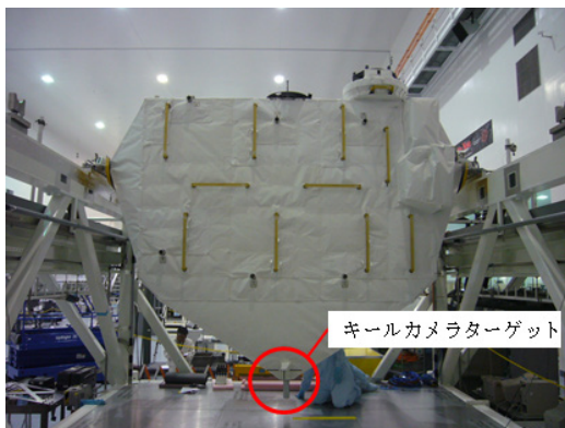
第 7 図 キールカメラターゲット取付(全景)
