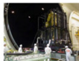
13mΦスペースチャンバに搬入されるALOS-2 (H24/10/16～熱真空試験実施中)
