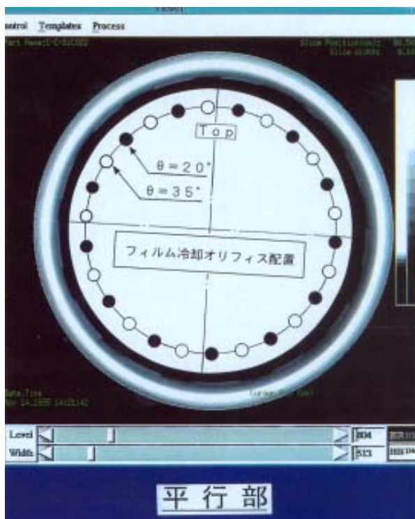
図21 T/N 5022後のX線 CT画像
