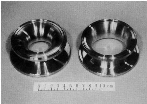
図 6. 750kW アーク加熱器の電極 (左側が電極形状 A、右側が電極形状 B)
