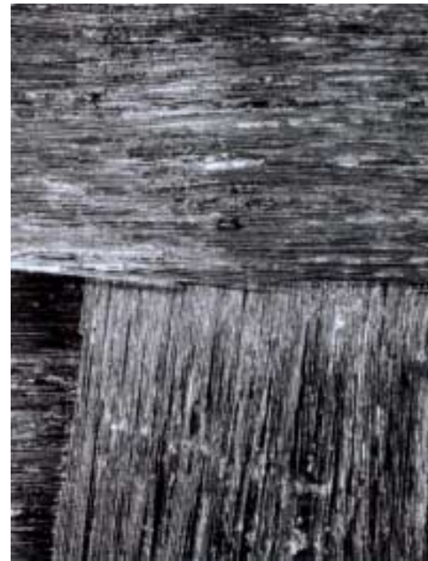
図2-11 直下の基材繊維の状況
