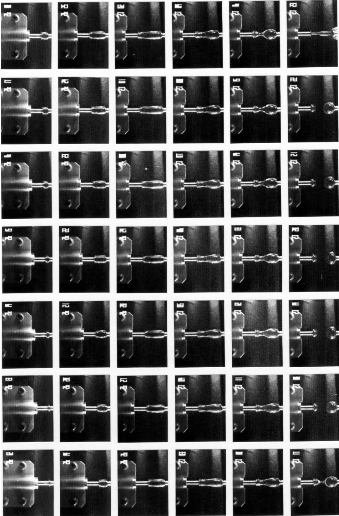
図 7-5 . 液柱形成形態 (一旦形成するが長さからくる不安定性のため切れる)
