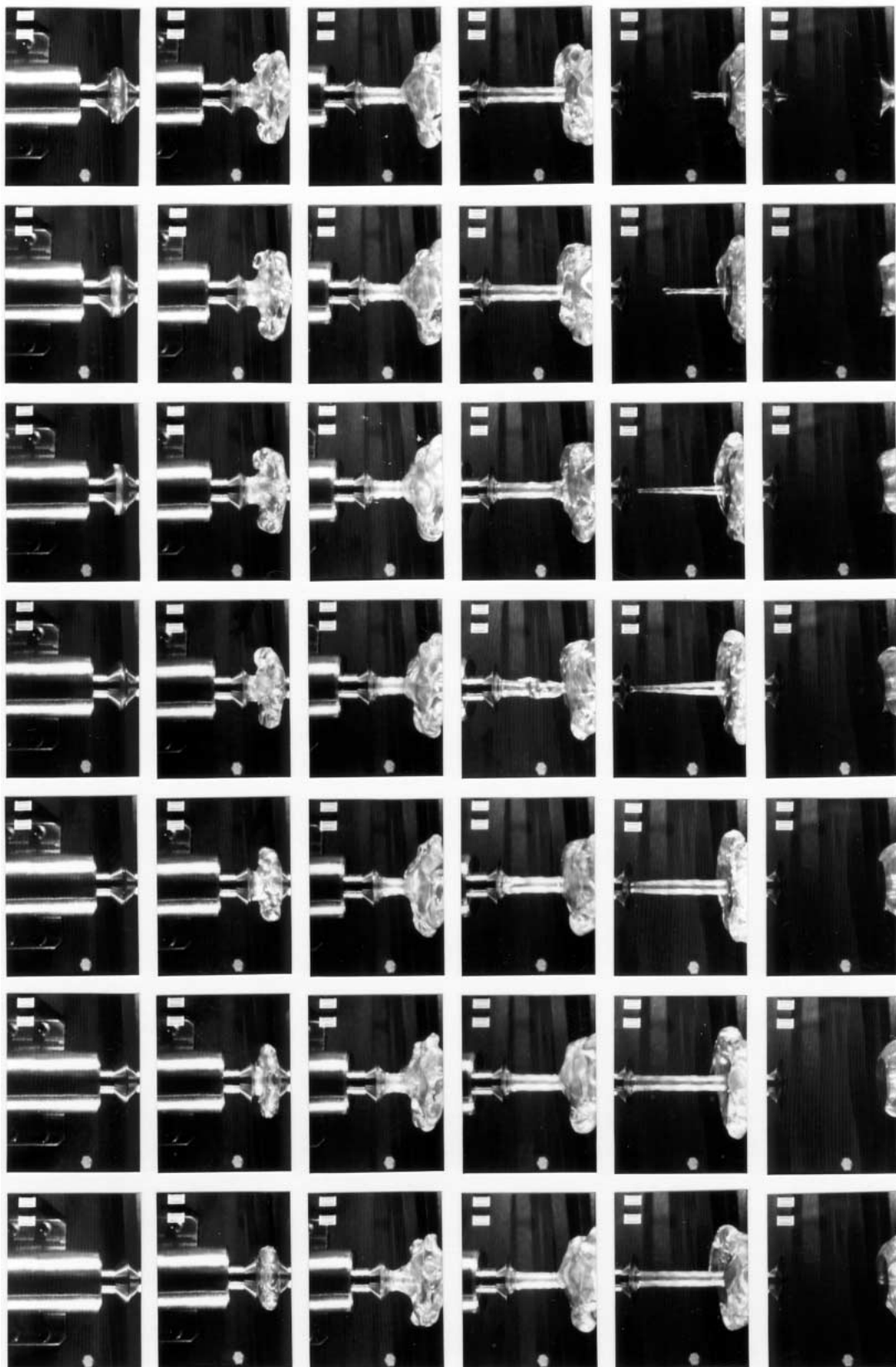
図 7-4 . 液柱形成形態 ( 吐出速度が速いため初期段階で飛び散る ) シリコンオイル 5cSt ディスク径 D = 2cm 液吐出穴径 d = 0.6cm 液柱長さ L = 4.05cm 液吐出速度 V = 4.19cm/s
