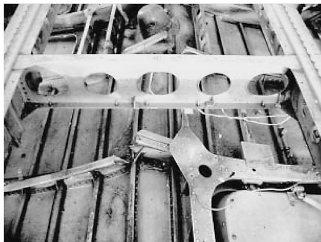
図 34 FSTA+3720 床下フレーム中央部の崩壊(破断)状況
