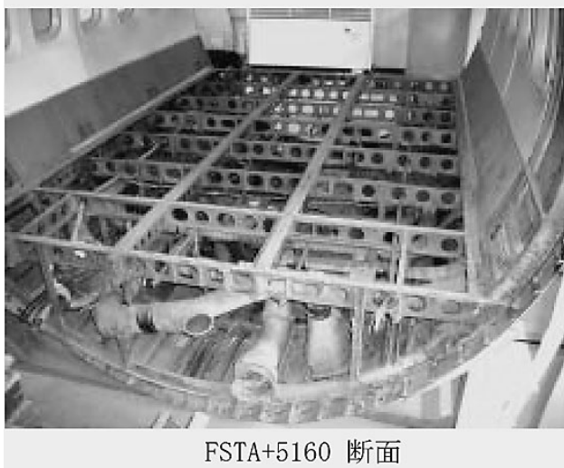
図5 改修前の供試体の状況
