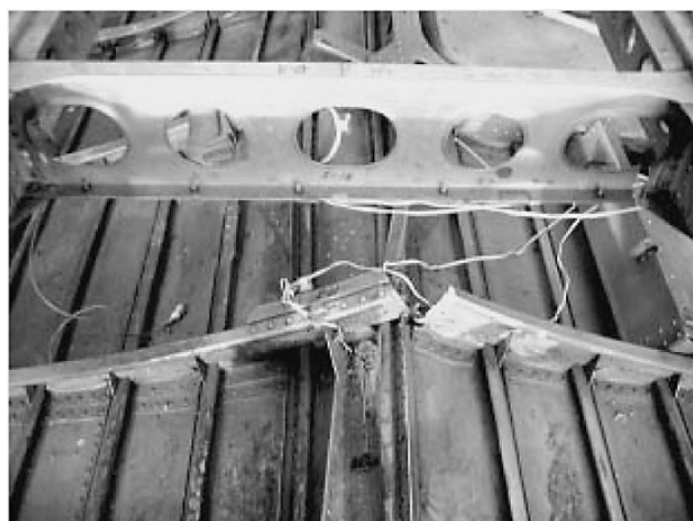
図 32 FSTA+2760 床下フレーム中央部の崩壊(破断)状況
