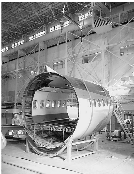
図8 供試体重心計測の状況
