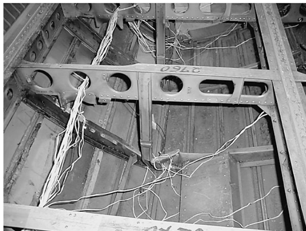
図 35 FSTA+2760 左ストラットの座屈状況 (供試体の後方より観測)
