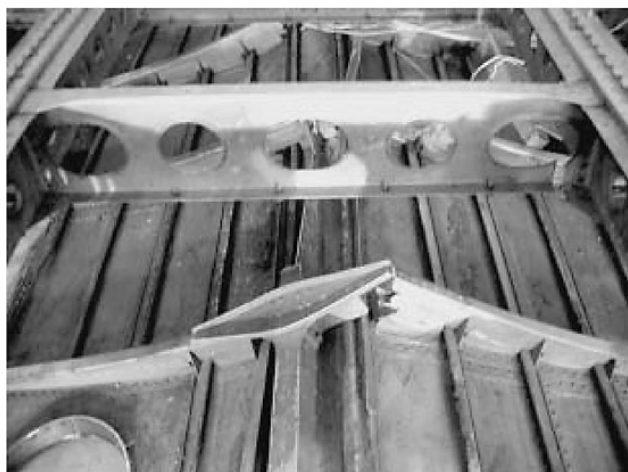
図 31 FSTA+2280 床下フレーム中央部の崩壊(破断)状況
