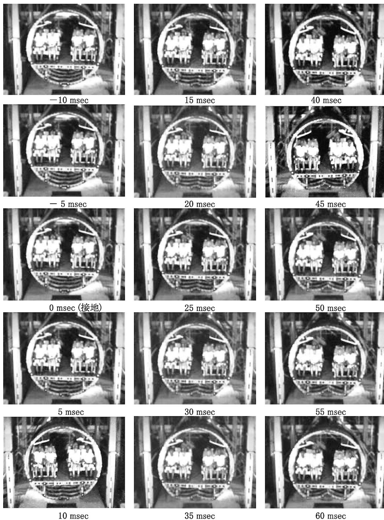
図16 高速度カメラ画像例 (接地前 10 msec より, 接地後 205 msec までの 5 msec 間隔毎画像, 記録条件: 撮影速度 1000 Frame/sec, 画像解像度 256 × 256 画素) -1/3
