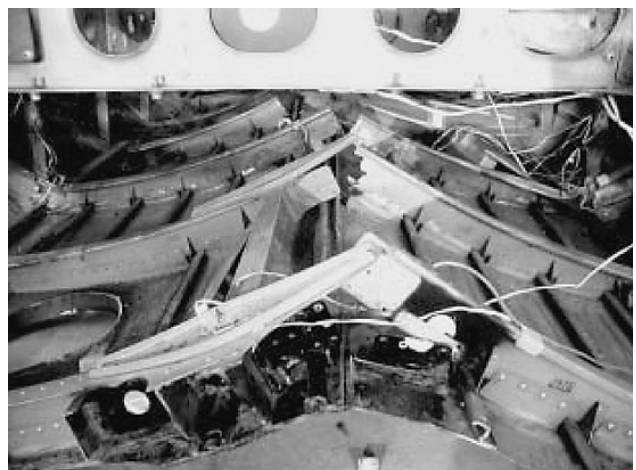
図30 FSTA+1800 床下フレーム中央部の崩壊(破断)状況
