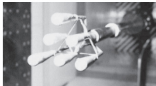
写真7 遷音速風洞で試験中の整形カバーを取り付けたデルタ形センサー
