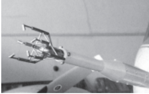
写真3 超音波風速計 1995
