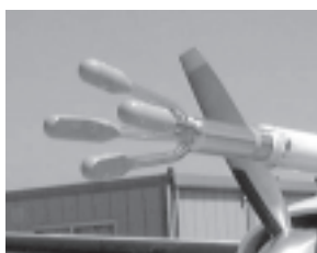
写真5 超音波風速計 1999
