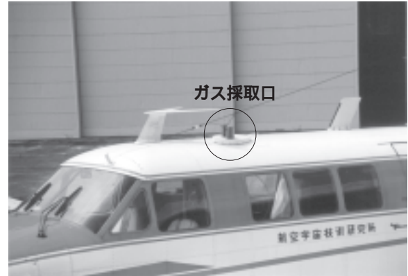
写真 10 クインエア機上部に取付けたガス採取口
