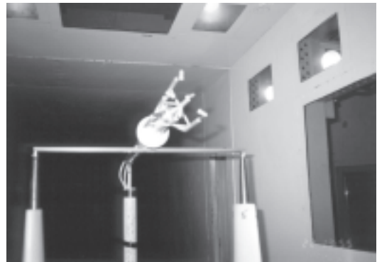
写真6 突風風洞で試験中の超音波風速計
