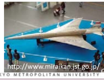
ワープ形状・クランクアロー翼
