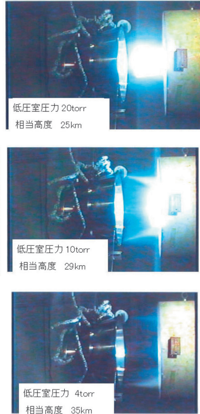
図14 デュアルベルノズル燃焼試験中の写真
