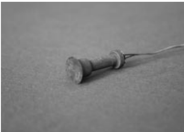
図3.13-4 C / C部温度センサモジュールの写真 (プラグ単体)
