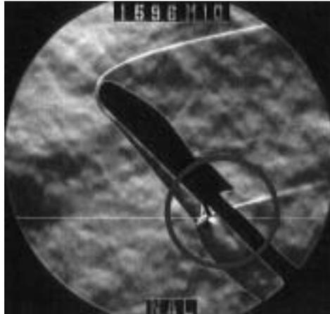
図46 エレボン左右対称操舵時 シュリーレン写真  $\delta e = 20^\circ$ ,  $\alpha = 45^\circ$   $\beta = 0$  極超音速風試
