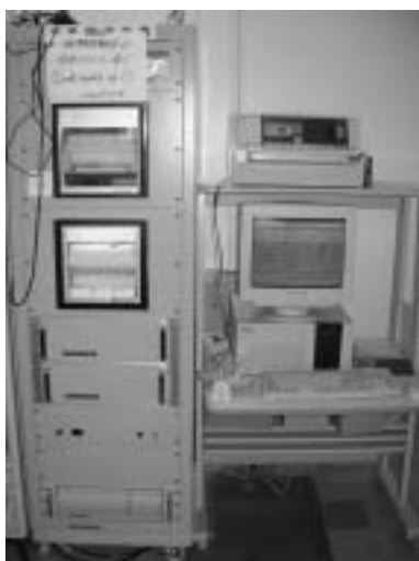
(a) 射点気象記録装置(左)と表示用コンピュータ
