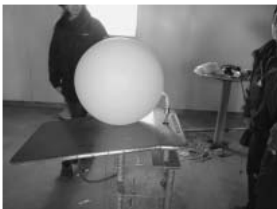
(b) バルーンへのヘリウムガス注入作業
