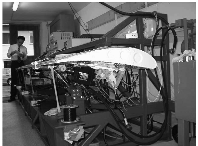
図4-3-6 DLCシステム試験用リグ
