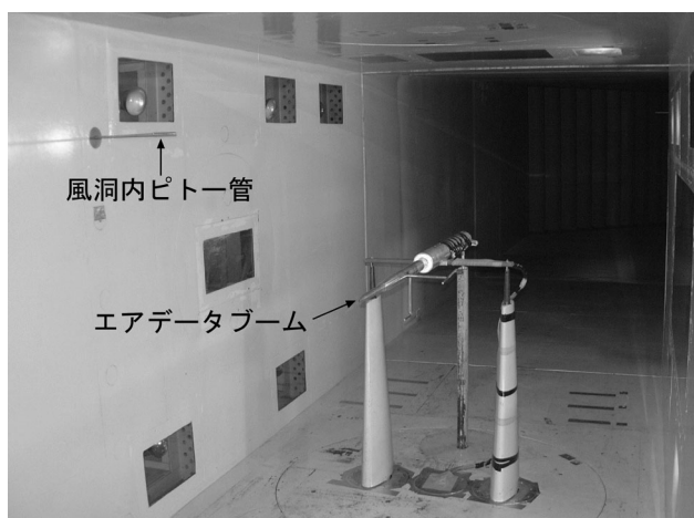
図 3.1 風洞試験におけるエアデータブームの設置状況
