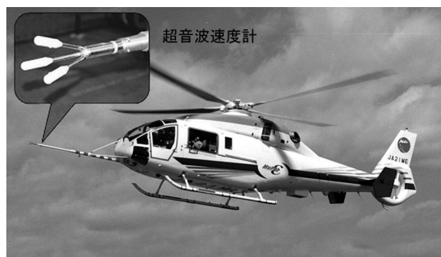
図1.2 実験用ヘリコプタ MuPAL-ε に超音波速度計を装備した形態（超音波速度計形態）
