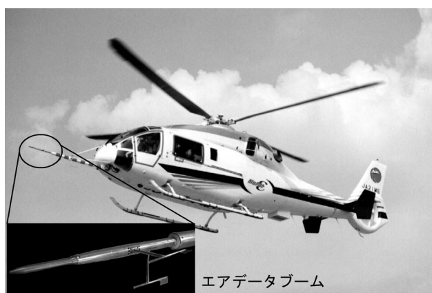
図1.1 実験用ヘリコプタ MuPAL-ε にエアデータブームを装備した形態（エアデータブーム形態）
