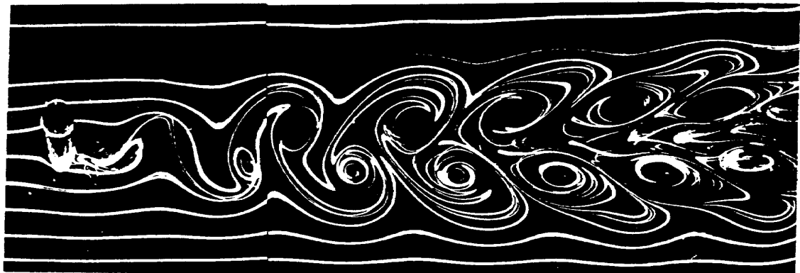
図17 実験による渦列, Re = 300 (P. Bradshaw)
