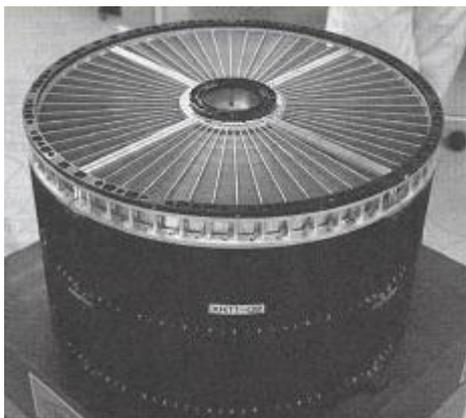
図 6-21 アルミ薄板 X 線望遠鏡
