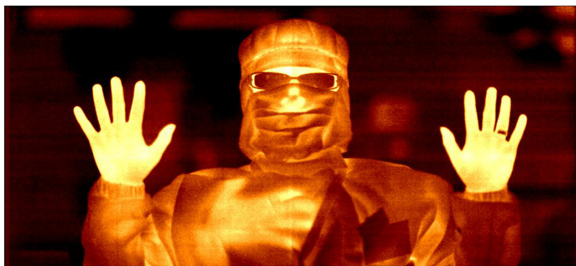
図 5-1. 試作した 200 万画素非冷却赤外検出器を用いて取得した熱赤外画像
