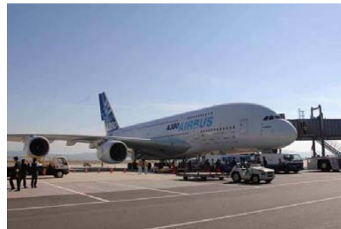
A380(2005年初飛行)一次構造/二次構造 CFRP使用量 約35トン
