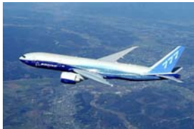
B777 (1994年初飛行) 一次構造/二次構造 CFRP使用量 約10トン
