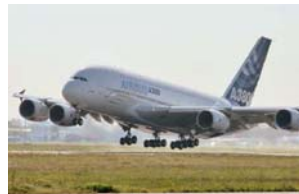
A380(2005年初飛行)一次構造/二次構造 CFRP使用量 約35トン
