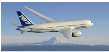
B787 (2009年初飛行) 一次構造/二次構造 CFRP使用量 約35トン
