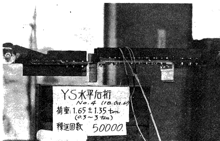
Fig. 6-4 供試体 No. 4 負荷状況
