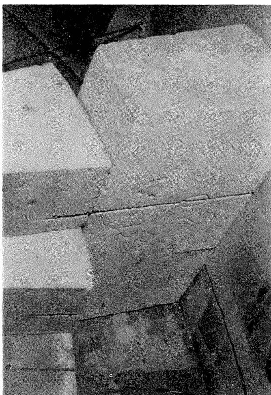
図 7 断熱材内部熱電対取付状況
