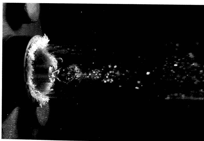
図 10 渦巻ノズルによる流れ
