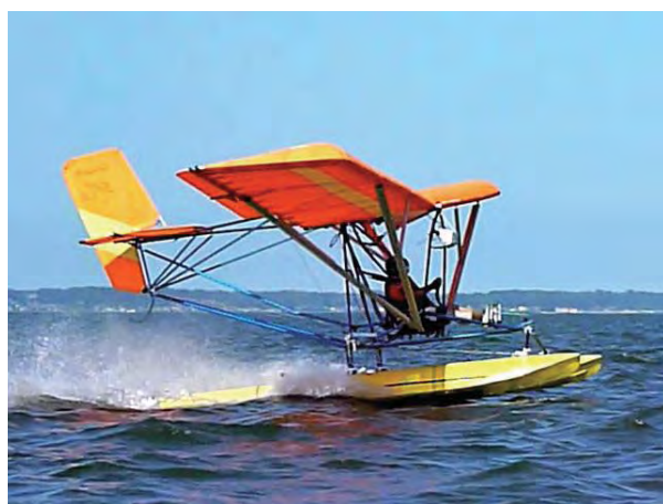
第6.高耐波性フロート実機試験 (波浪中)
