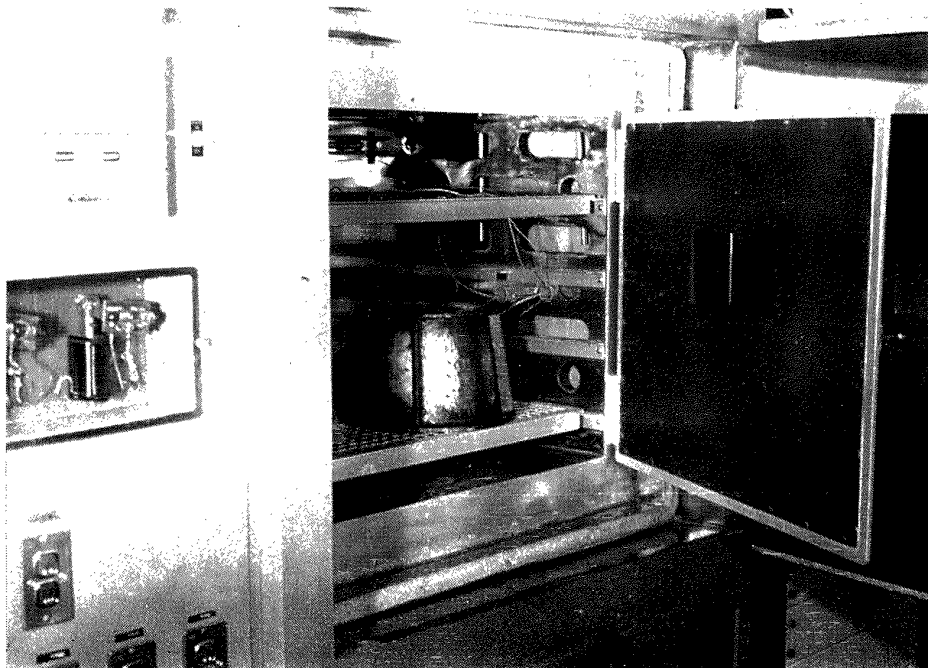
図11 温度サイクル試験炉の内のNAL-25型モータノズル模型試験片
