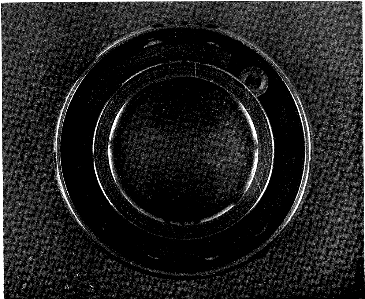
図 40 試運転後の円筒ころ軸受
