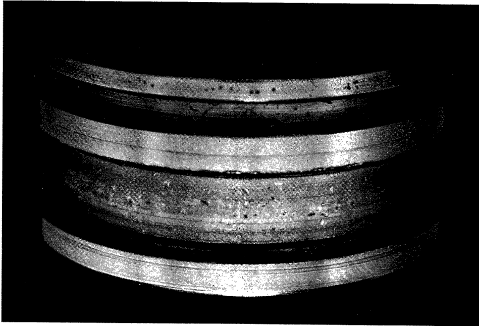
図 42 内輪軌道面の損傷
