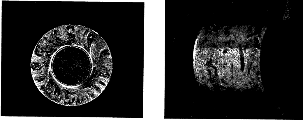
図 41 ころ端面，転動面の損傷
