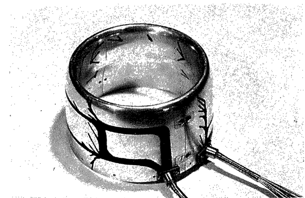
図 3 (a) 横風試験用ナセル (基本型)
