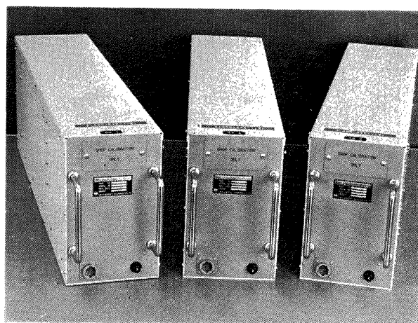
図 2.2.2 アンプリファイヤ・コンピュータ
