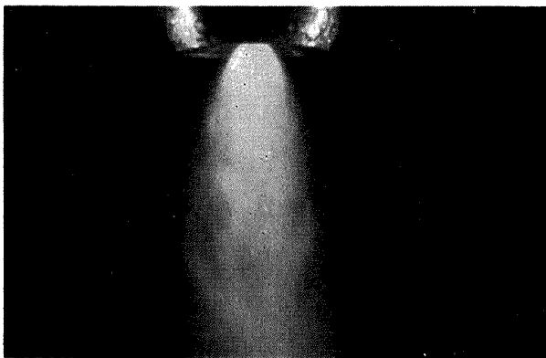
図 5-2 周囲空気圧力 40 kg/cm 2 ，噴霧 圧力 70 kg/cm 2 の場合の噴霧シース形 状
