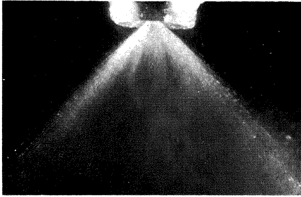
図 5-1 周囲空気圧力大気圧，噴射圧力 30 kg/cm 2 の場合の噴霧シース形 状
