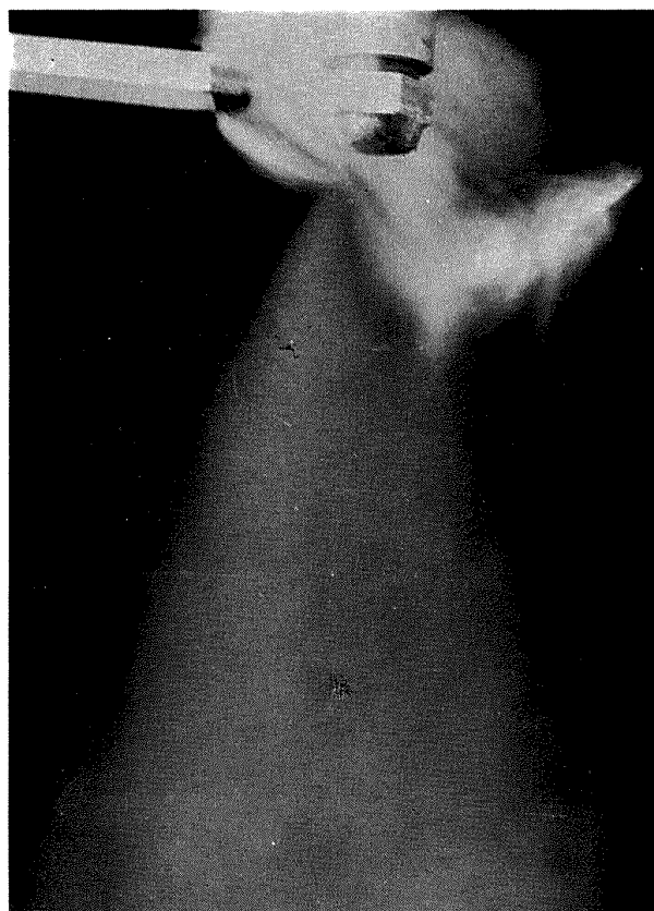
図 12 噴射弁から窒素ガスを吹いた場合のシース形状（棒状バルサンの発煙により可視化した。）
