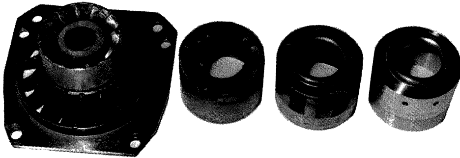
図2 二重スワラの外観 (左端のスワラは試作噴射弁用のもの)
