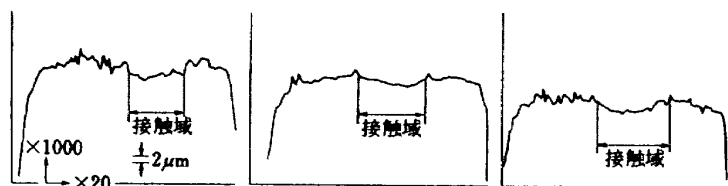
図53 保持器ポケットの軸方向直線度(試験後)
