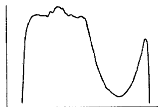
図54 保持器ポケットの円周方向直線度(試験後)
