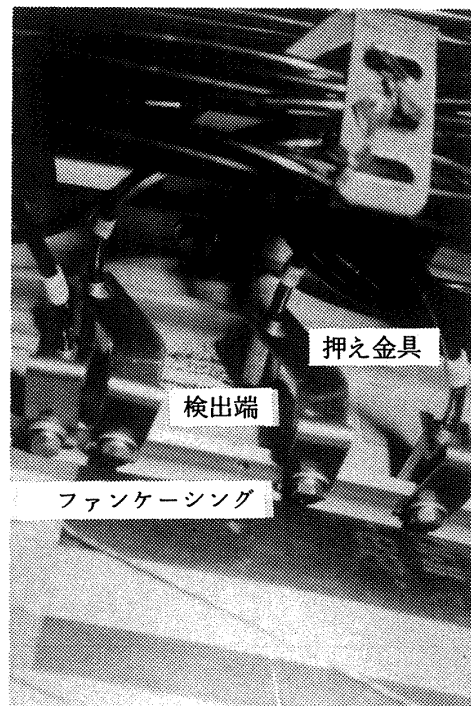
図 64 FJR710 (動翼先端検出器の装着)
