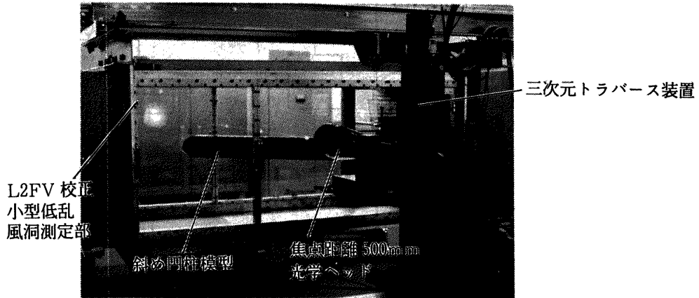
(a) 三次元トラバース装置に設置した焦点距離 500mm の光学ヘッドを用いた測定風景 (図 32 参照)
