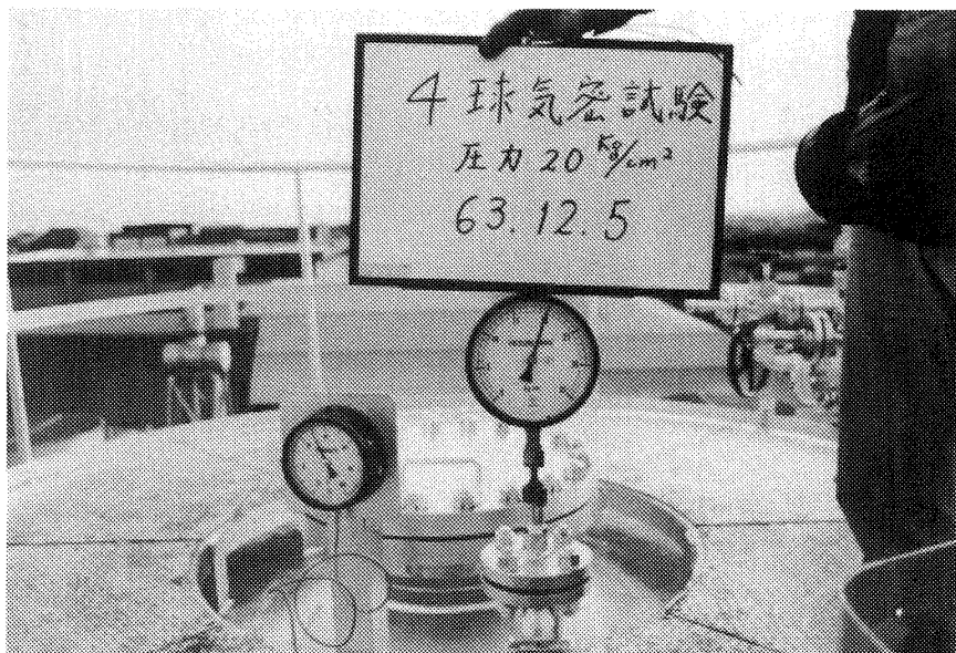
写真7 気密試験圧力
