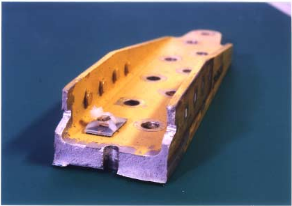
図 74. 主桁フランジの破断面
