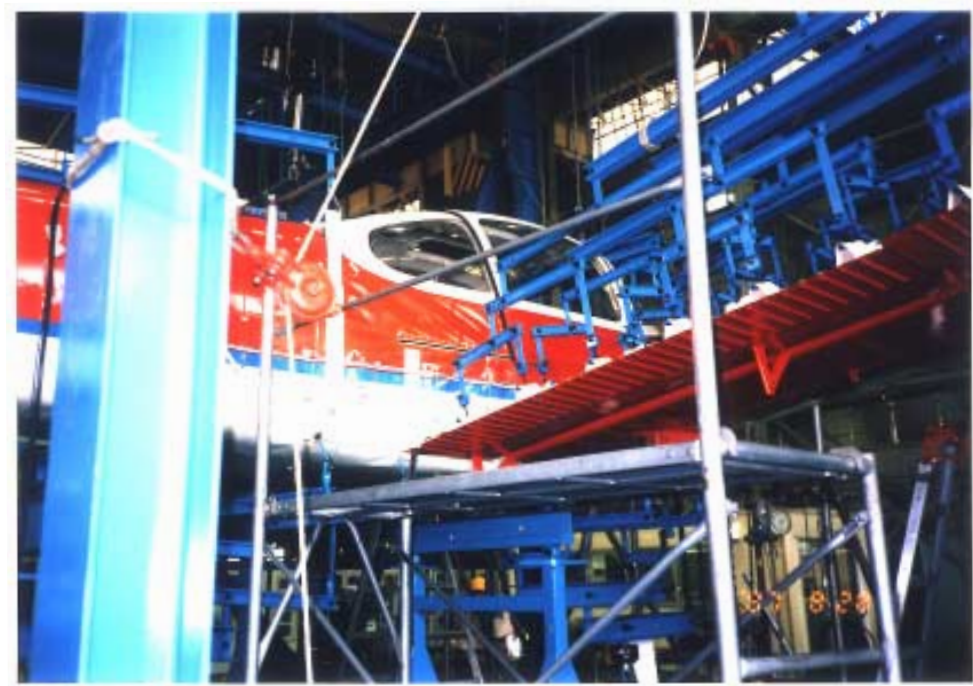
図 36－3. 胴体外板の局部弾性座屈
