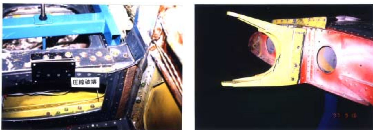
図 58. 供試体破壊状況
