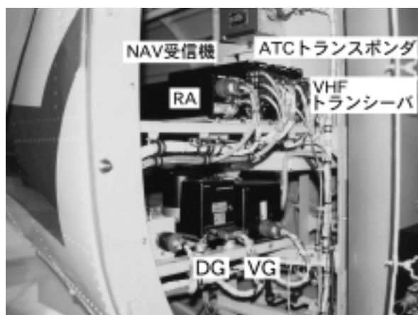
図 3.10.2 母機搭載の垂直ジャイロ (VG) と方位ジャイロ (DG)
