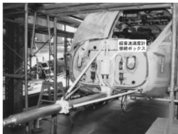
図 3.2.2 ノーズブームの取り付け構造
