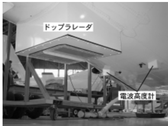
図 3.13.1 ドップラレーダの取り付け
