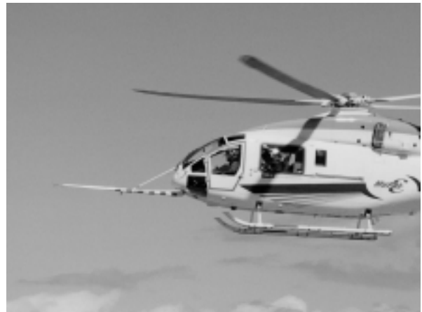
図 3.3.2 超音波速度計を装着して飛行中の MuPAL-
