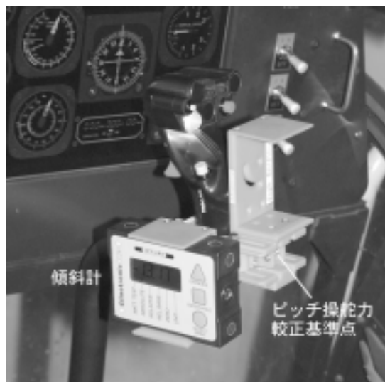
図 9.2.1 操舵量 / 操舵力校正装置
