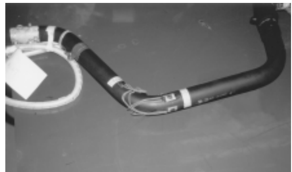
図 3.4.5 操舵力センサ (サイクリック・スティック)
