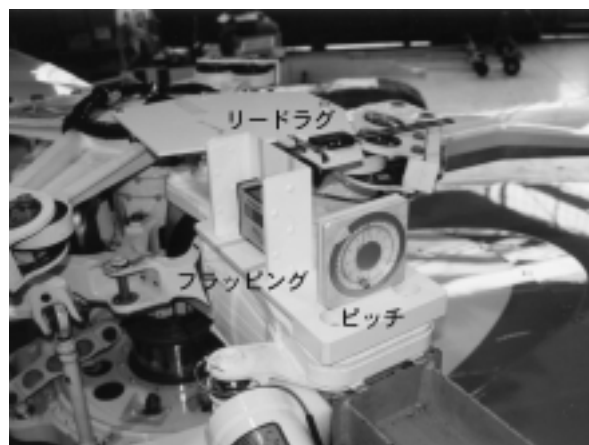
図 9.3.1 ブレード角度校正装置
