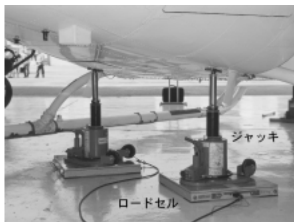
図 9.5.1 重量重心計測の様子
