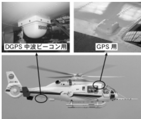
図 3.1.3 GPS 用アンテナと中波ビーコン用アンテナの配置
