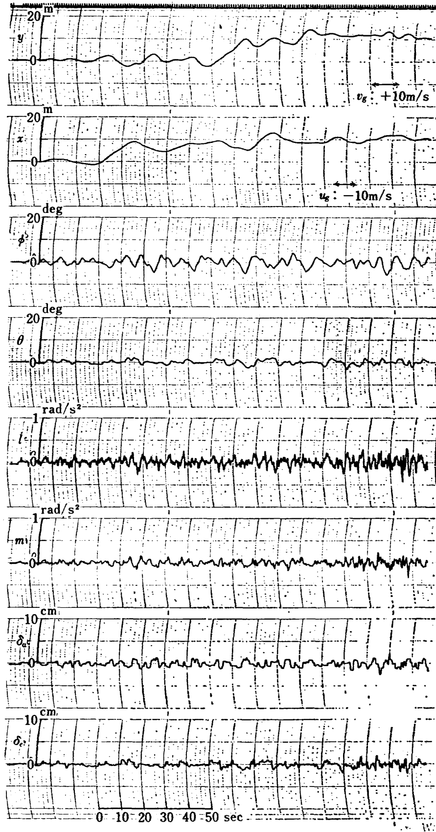
図 4.15(b) シミュレーション実験記録 ( (I_p)_A = -6, (I_\phi)_A = 0, (m_q)_A = (m_\theta)_A = -3 の場合)
