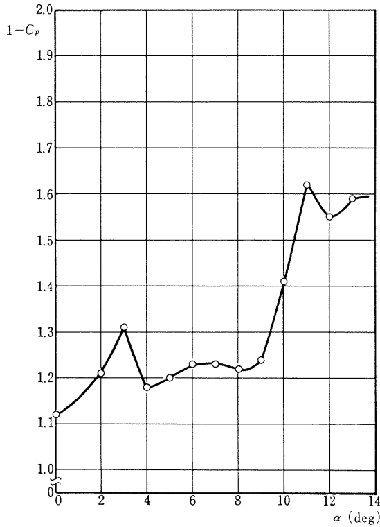
図 12 75% 翼弦長点における表面圧力の迎角に対する変化 (上面) ( R=0.54 \times 10^5 )
