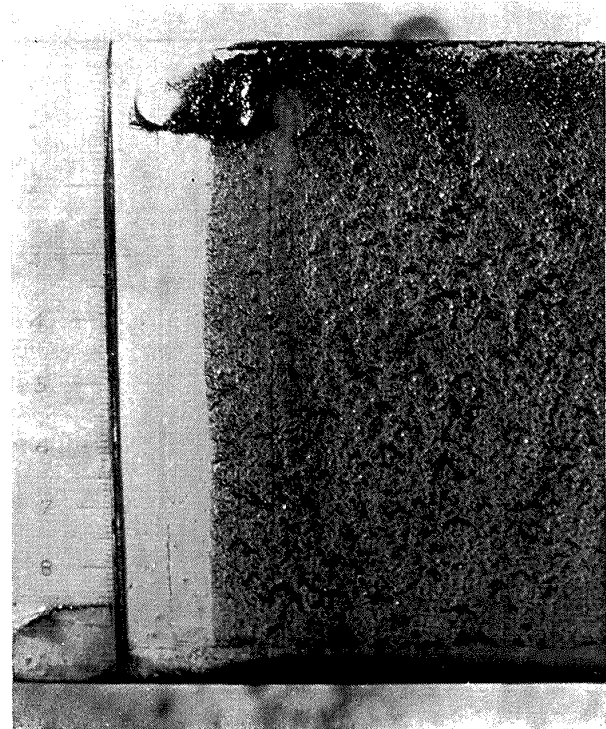
図 13 b 油膜模様の一例 ( R=0.54 \times 10^5 , \alpha=16^\circ )
