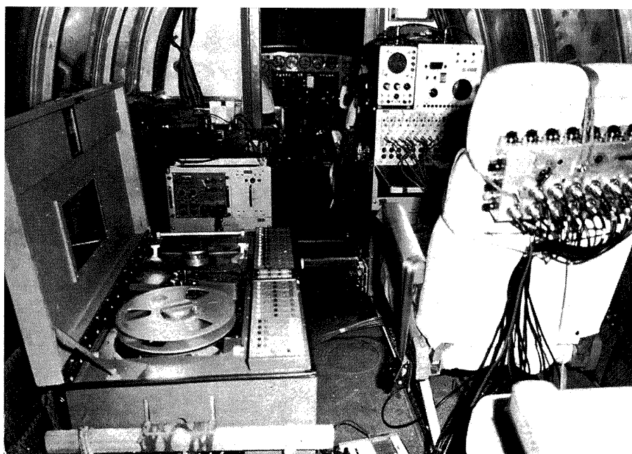
図 10 計測器の機内配置
