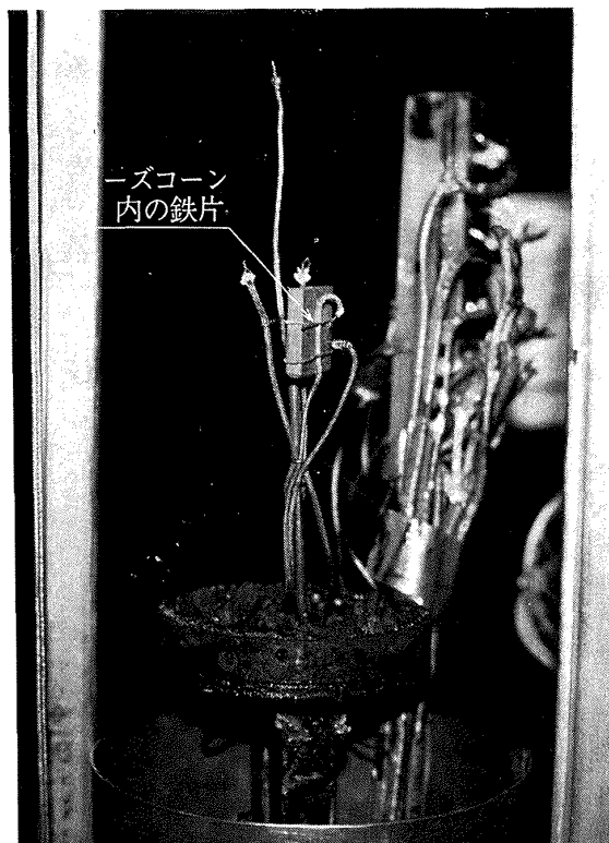
写真 3.7 ノーズコーン内部空気温度と鉄片温度の測定熱電対
