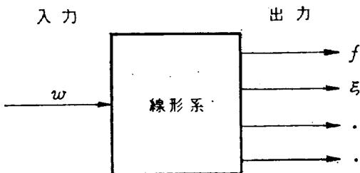
図 C.1 線形系への入力と出力
