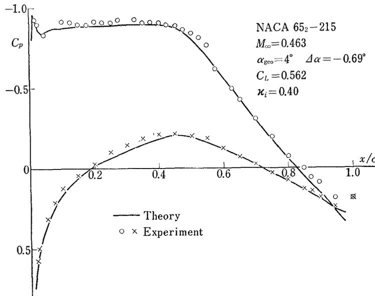
Fig. 9 (d) Pressure Distributions on the NACA 65<sub>2</sub>-215 Model,  $M_{\infty}=0.46, \alpha=4^{\circ}$
