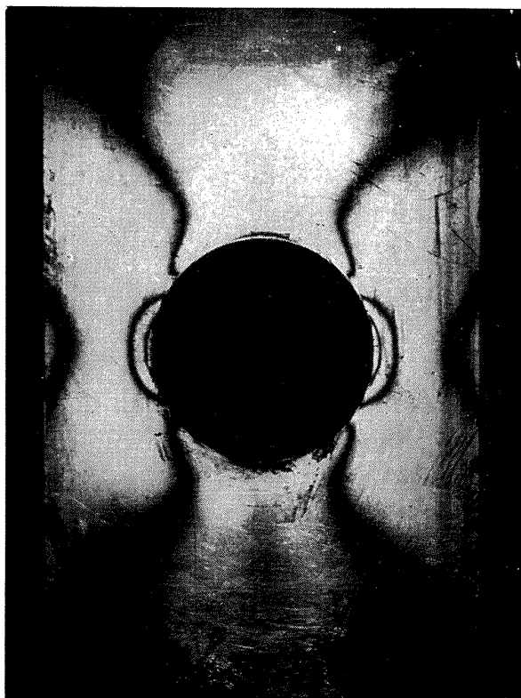
被 膜 厚 さ: 1.27 mm 下地試験片の厚さ: 2.03 mm \lambda : 0.50 \zeta : 0.40 (a) 硬い被膜材のとき
