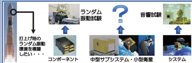
宇宙機は打上げ時、過酷なランダム振動環境に曝される。これを模擬するための試験方法にはランダム振動試験と音響試験があり、適切に選択する必要がある。一般的に、コンポーネント等の小型構造物はランダム振動試験、衛星システム等の大型構造体は音響試験がより現実に近い環境になることが分かっている。しかし、中型サブシステムや100kg級小型衛星については、どちらの試験が有効か明確な指針がなく、設計者の経験に頼るところが大きい。
