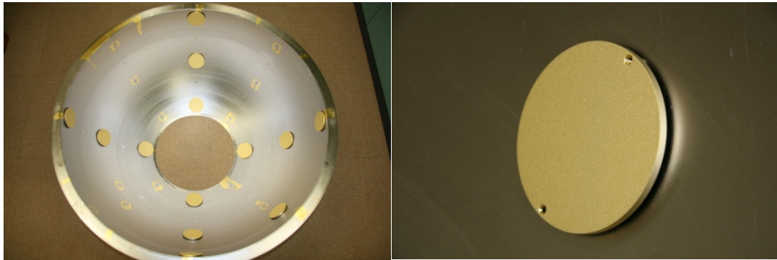
図6-3 金蒸着後の半球とウィットネスサンプル
