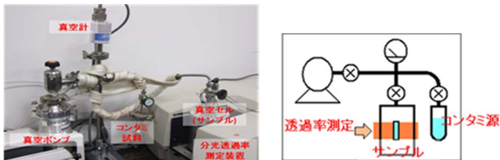
図7-1 測定装置の概要
