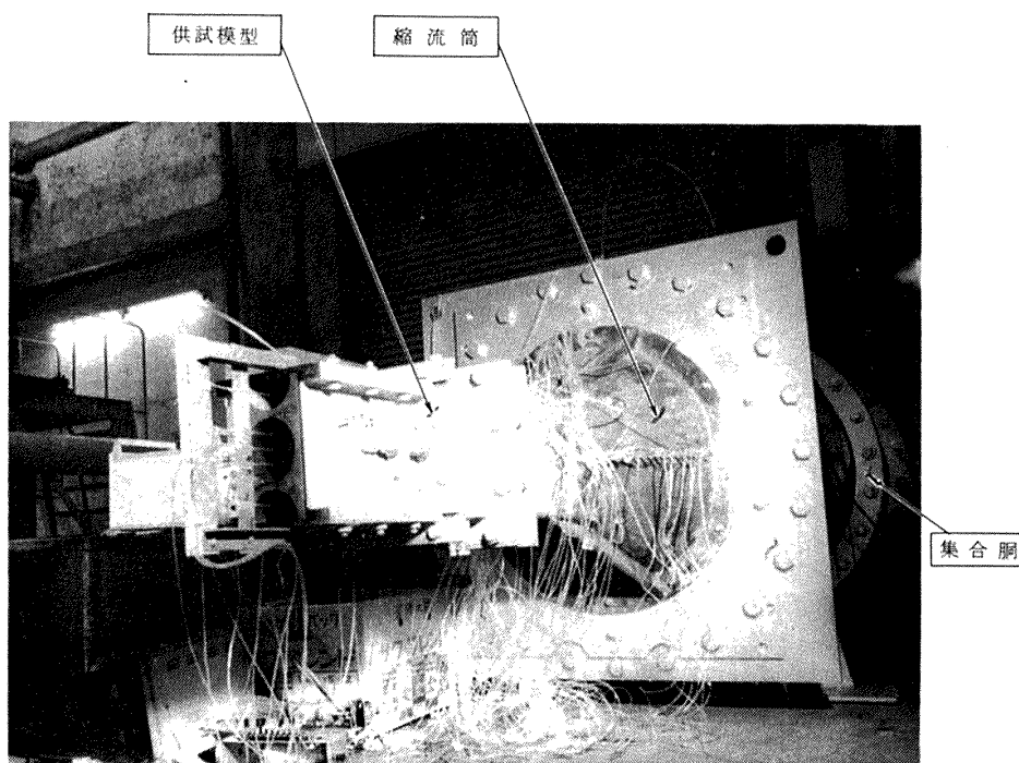
図 5 (b) ブラグ型調圧弁模型 (Diffuser With) 取付の様様
