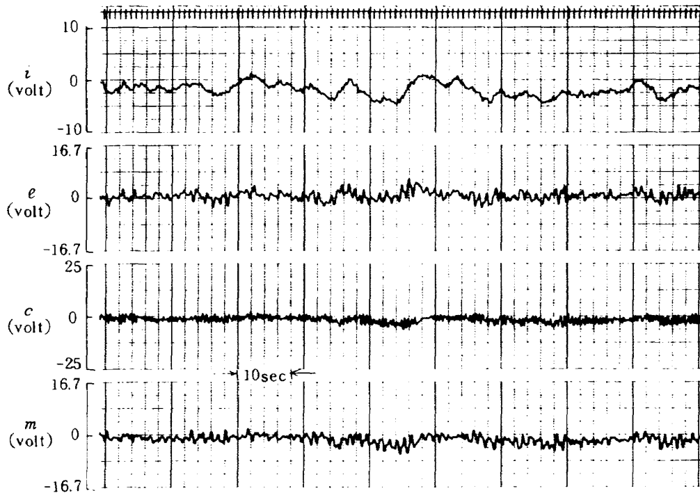
図 16-2 ペン書き記録例 E026, KWH. Y_c = \frac{25}{s^2 - s + 25} , \omega_i = 0.75[\text{rad/sec}]
