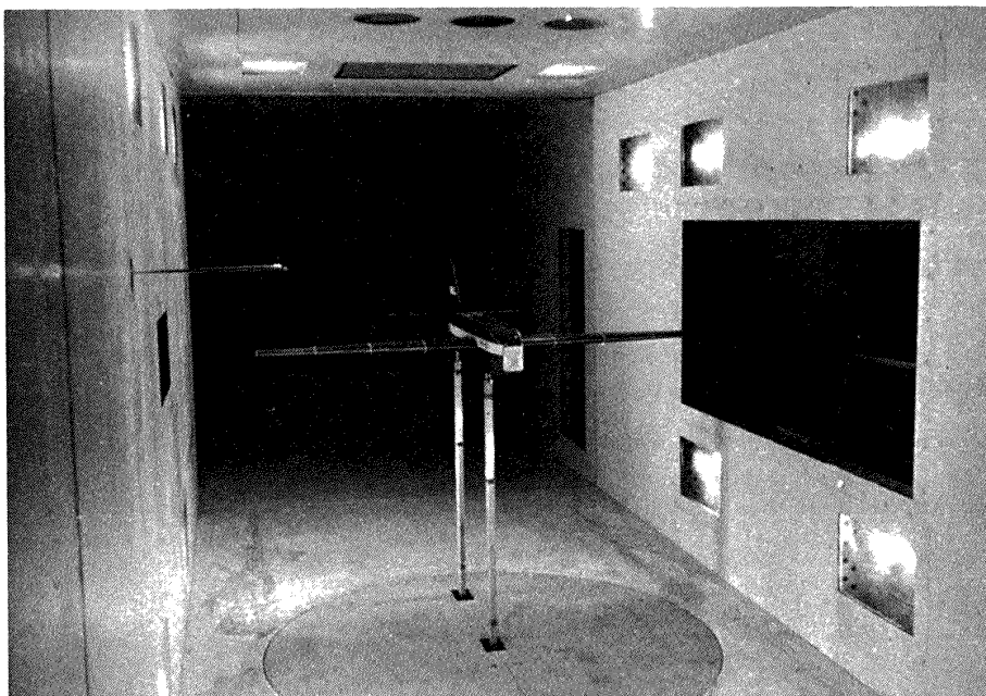
図6 上下動加振装置の突風風洞内実験状態
