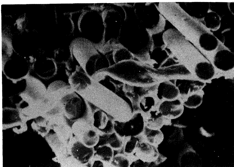
図 32 引張破断面の拡大写真
