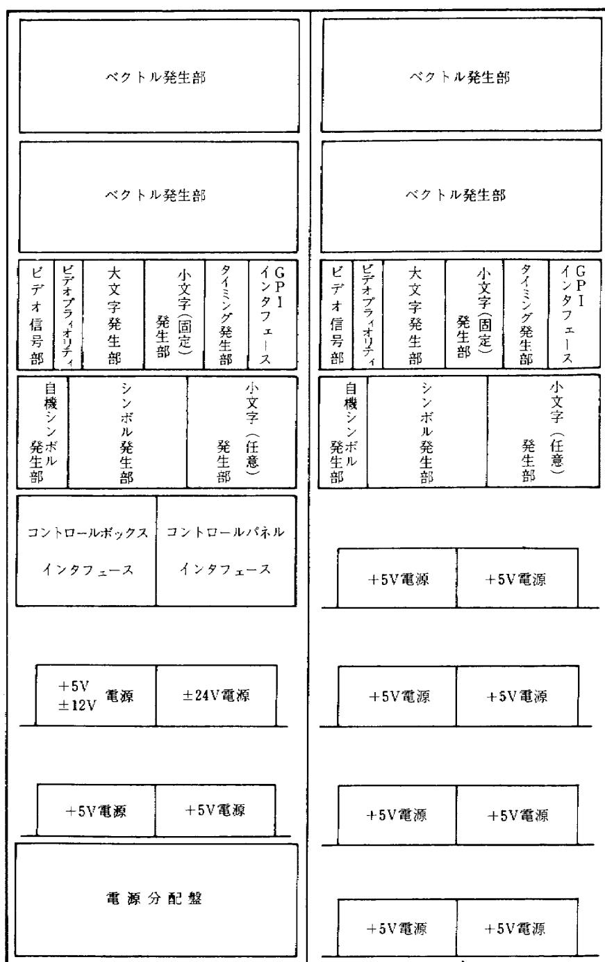
図3-12 ディスプレイプロセッサラック実装図
