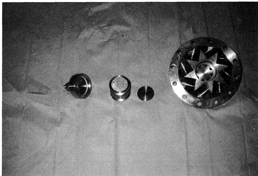
図10 \text{H}_2\text{O}_2 分解ガス噴射システム
